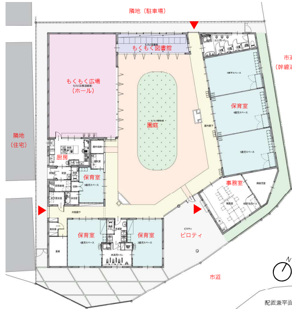
保育室とホールで園庭を囲む。正面に大きな図書館。連絡する方柱がリズムカルに軒を支える。ロフトの余剰スペースは空調室外機置場として活用。
